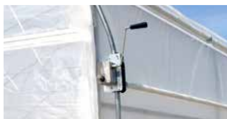
Progressore manuale a sforzo ridotto Low-effort manual gear
