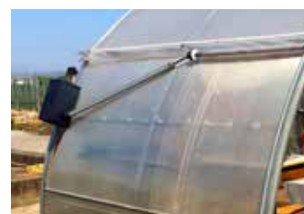
Braccio cardanico telescopico manuale e motorizzato Manual and motor-driven telescopic arm
