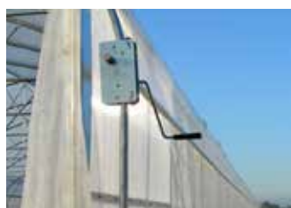
Progressore manuale a sforzo ridotto Low-effort manual gear
